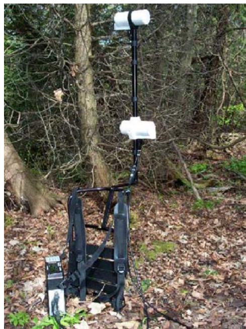
Рис. 5.11.1 Магнитометр GSM-19 в рабочем положении
